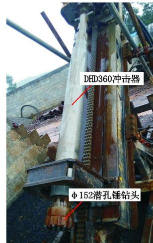
图5 DHD360型冲击器及 $\text{Ø}152$  mm潜孔锤钻头
