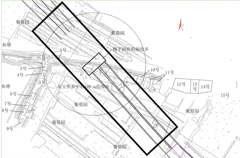
图1 南京长江隧道降水井平面布置图
