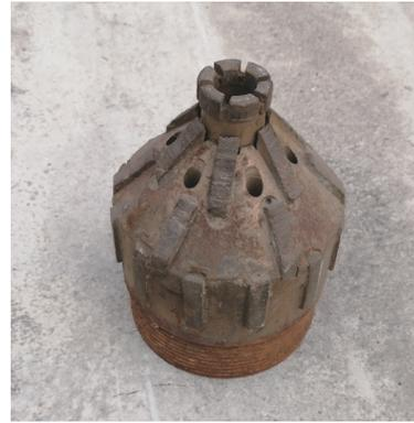
图 4 Ø130 mm 金刚石锥形磨孔钻头
