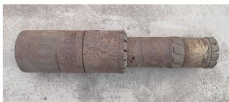
图 3 Ø95/130 mm 组装式扩孔钻头
