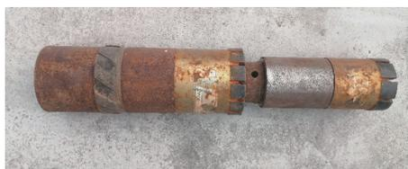
图 2 Ø76/95 mm 组装式扩孔钻头
