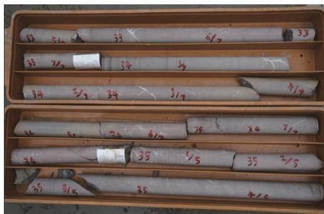
图5 钻孔采取的岩心
