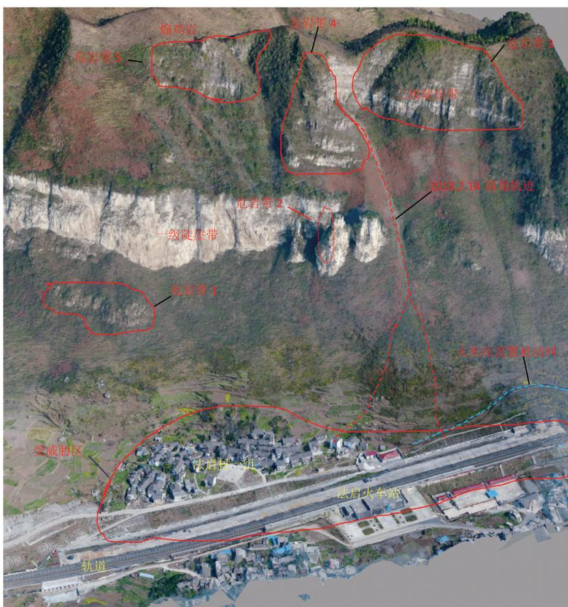
图 1 法启村一组崩塌地质灾害隐患全貌
