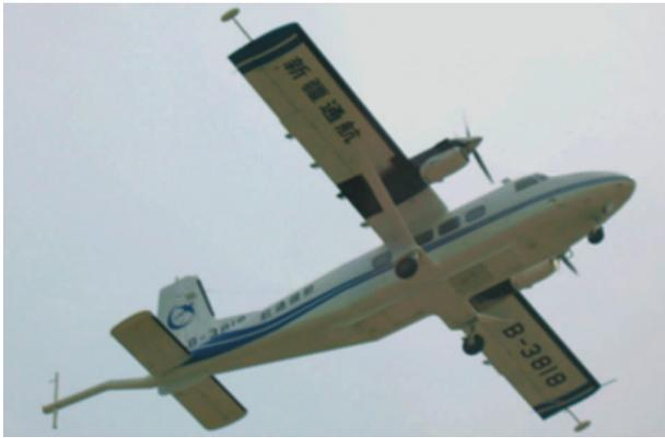
图1 三维梯度测量磁探头实际安装图
