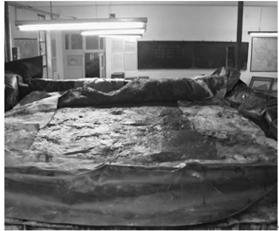
图 2 真空预压后的试验土层
