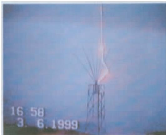
图 11 人工引雷击中消雷器的照片
