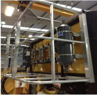
图 5 电控采水器
