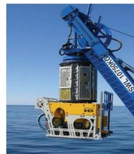
图 11 顶置式中继电器
