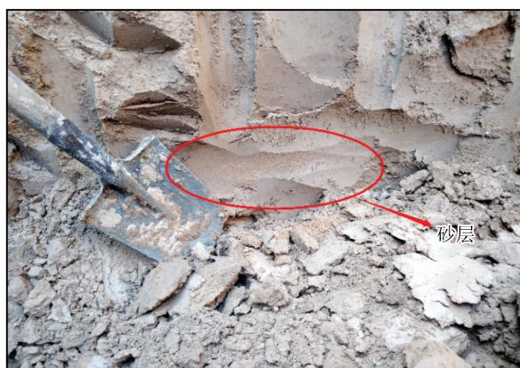
图7 探槽内砂层
