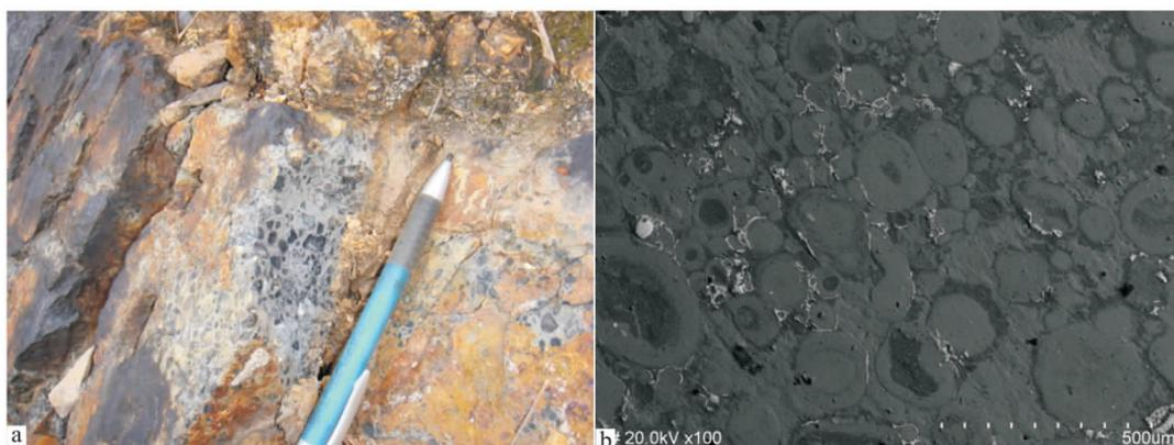
图3 豆、鲕状铝土矿宏观露头(a)及显微结构照片(b)
