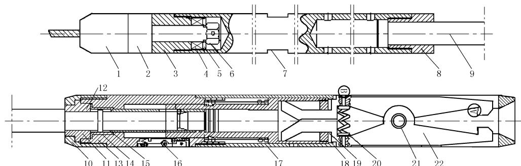
图1 安全打捞器结构图
