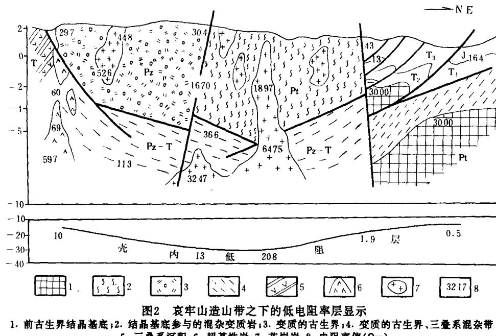
图2 哀牢山造山带之下的低电阻率层显示
