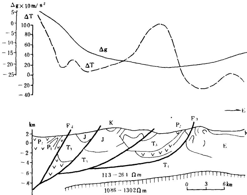
图3 平川推覆构造航磁、重力、大地电磁成果地质综合解释图
