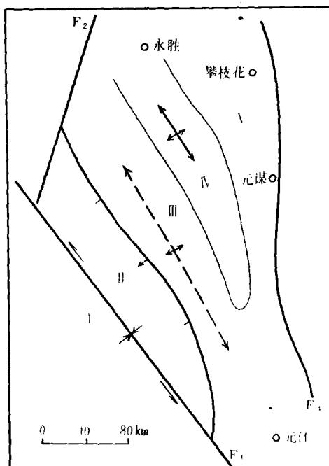
图5 楚雄地区中、晚三叠世构造应力及其构造形迹
