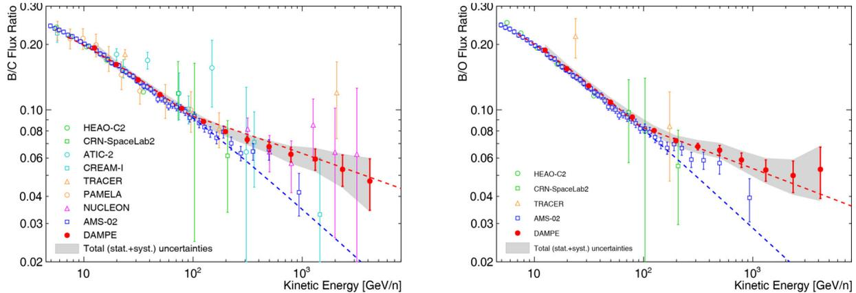
图 4 DAMPE硼碳(左图)和硼氧(右图)比例随能量的变化<sup>[31]</sup>. 其他实验结果来自HEAO-C2<sup>[52]</sup>、CRN-SpaceLab2<sup>[53]</sup>、ATIC-2<sup>[54]</sup>、CREAM-I<sup>[55]</sup>、TRACER<sup>[56]</sup>、PAMELA<sup>[57]</sup>、NUCLEON<sup>[58]</sup>和AMS-02<sup>[45]</sup>.
