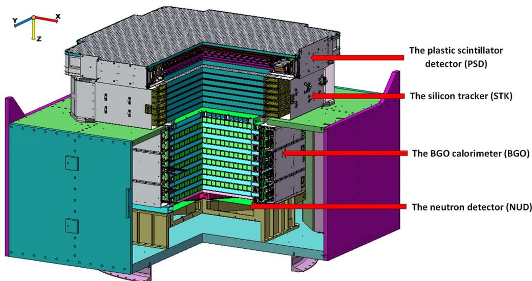
图 1 DAMPE探测器配置图<sup>[25]</sup>
