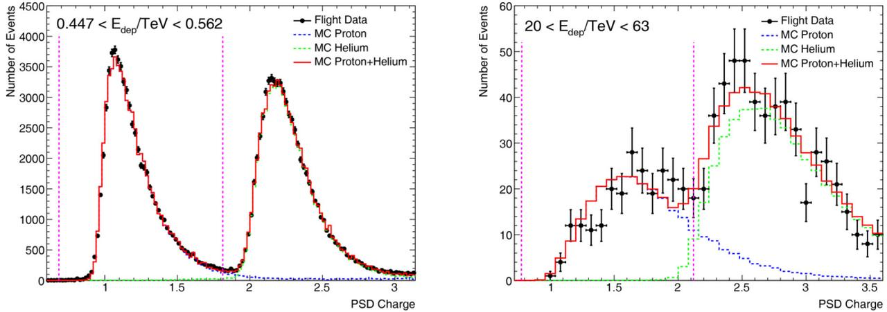
图 2 DAMPE塑闪探测器测得的质子和氦核在两个沉积能量( $E_{\text{dep}}$ )段的电荷分布<sup>[27]</sup>. 黑色点为飞行数据, 蓝色和绿色虚线分别为Monte Carlo (MC)模拟的质子和氦核电荷分布, 红色实线为模拟质子和氦核总分布. 这里的“电荷”由PSD能量转化而来, 并未归一到质子和氦核的真实电荷数值.
