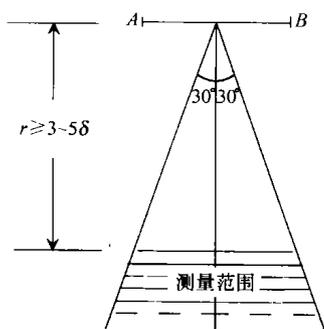
图1 CSAMT赤道偶极装置标量测量示意图
