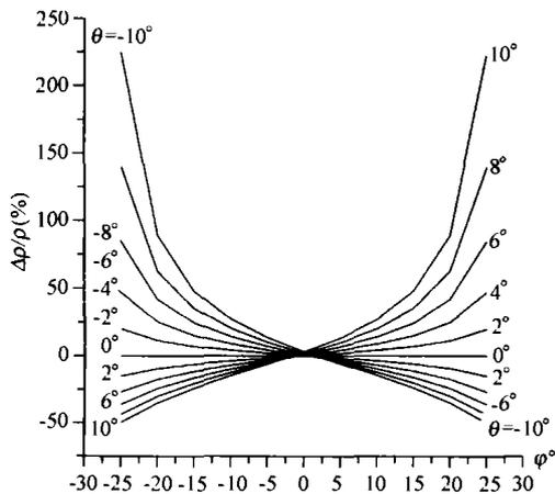
图 3 电阻率误差与  $\theta$  角和  $\varphi$  角的关系特征曲线
