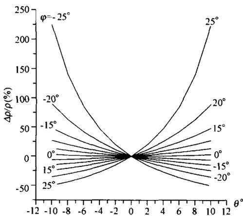
图 4 电阻率误差与  $\varphi$  角和  $\theta$  角的关系特征曲线
