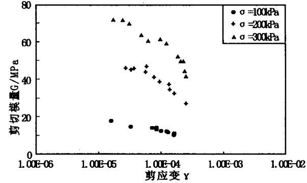
图2 不同围压 $\sigma$ 下饱和粉砂的动剪切模量 $G$ 与剪切应变 $\gamma$ 的关系(引自刘雪珠,2003)
