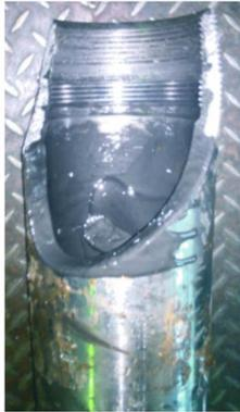
图8 粘扣反扣接头
