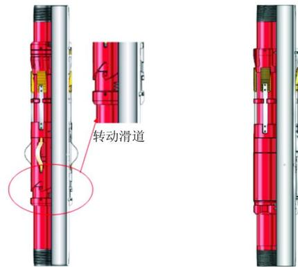
图3 机械式悬挂总成
