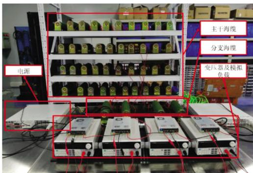
图 6 海底观测网原型系统实验配置
