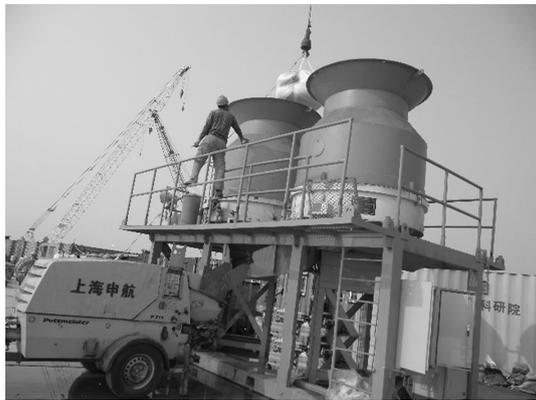
图1 海上风电导管架灌浆作业装置
