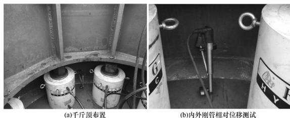
图4 千斤顶布置和内外钢管相对位移测试
