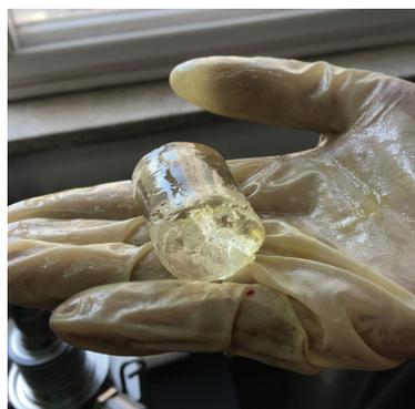
图7 堵漏用凝胶样品
