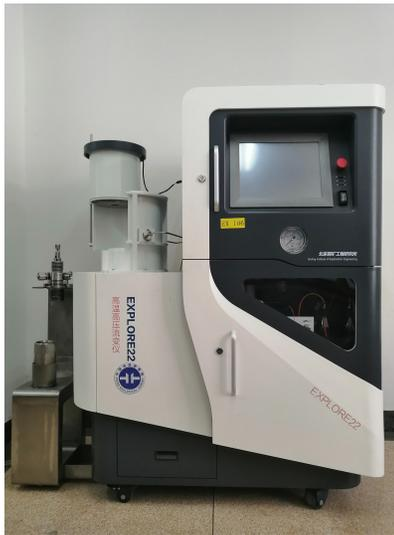
图3 超高温高压流变仪实物
